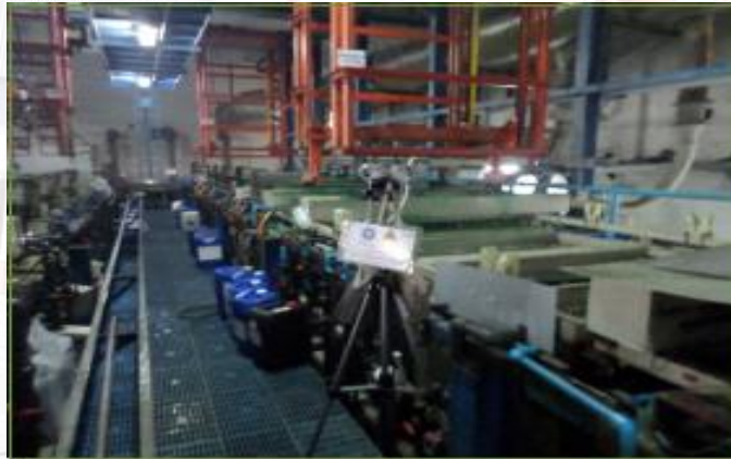
การตรวจวัดปริมาณ Total dust, Nickel (Ni), Copper fume (Cu fume) และ Chromium (Cr) บริเวณ ห้องซูป (Auto) : กลาง Line B
